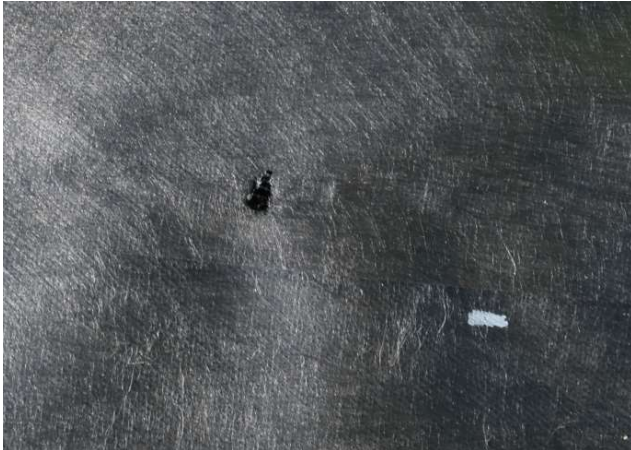
Figur 23 Exempel på "hål" orsakat av svets maskin
