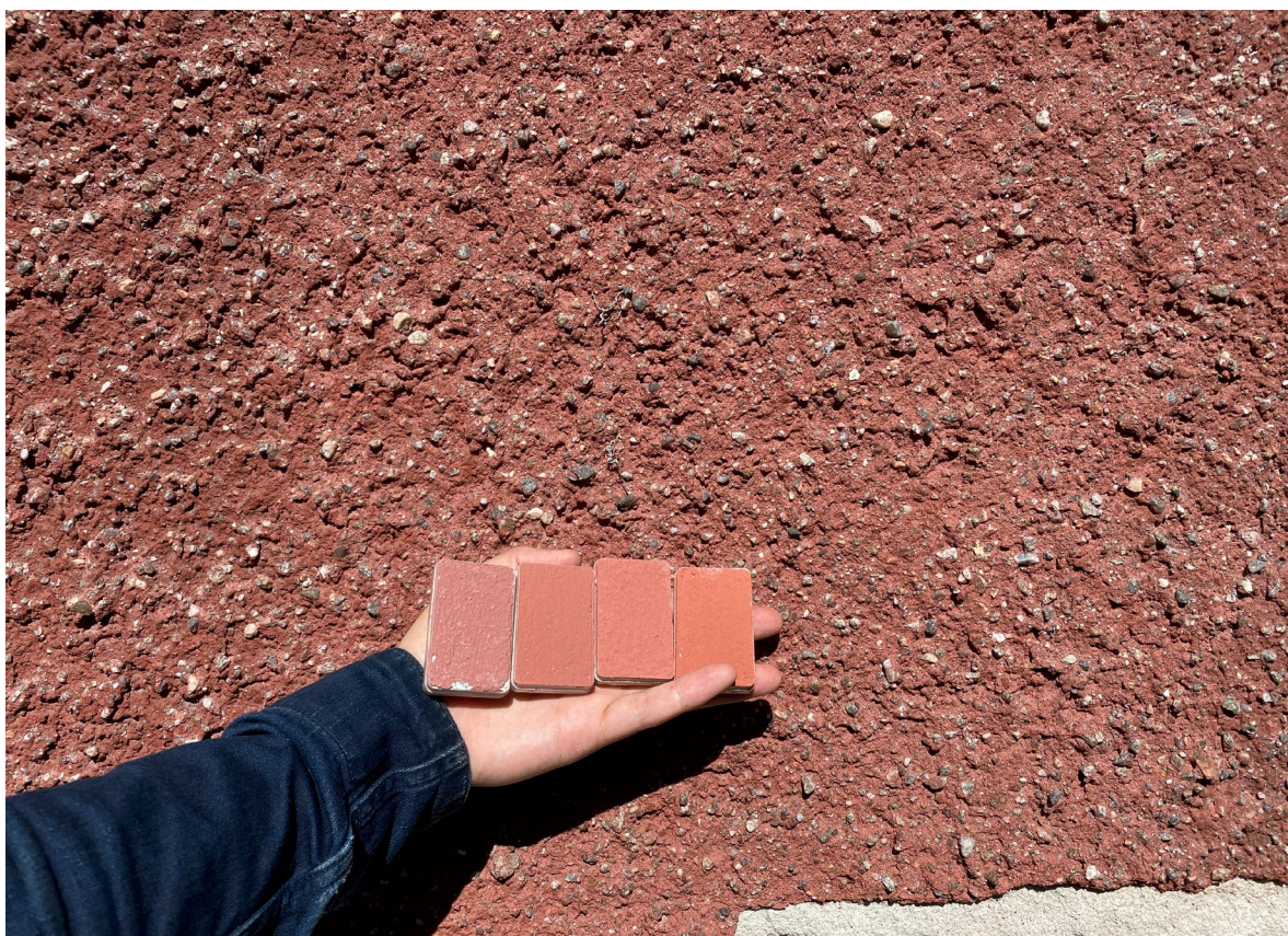
Bedömning av prover mot originalputs på Vivstavarvsvägen. Notera att proverna är framtagna utifrån samma NCS-kod.
